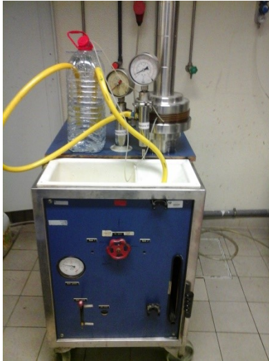
Figura 9. Fotografia e esquema da instalação Lab-Unit M20. 1. Tanque de alimentação; 2. Válvula; 3. Filtro de segurança; 4. Bomba de alta pressão; 5. Válvula de by-pass (ou de agulha); 6. Permutador de calor; 7. Manómetro; 8. Módulo de pratos planos (" plate and frame "); 9. Colector de permeado; 10. Válvula reguladora de pressão (Cui et al. 2010).
